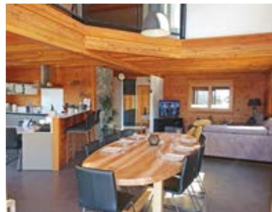
Ce chalet a été conçu et fabriqué par Les Établissements Boucaud, puis livré en kit prêt au montage. Il fait appel à la technique du madrier empilé avec isolation incorporée, gage d'une isolation thermique renforcée, d'une facilité et rapidité de montage. En 12 jours, aidé de trois personnes, dont un instructeur monteur, le chalet était hors d'eau/hors d'air !
